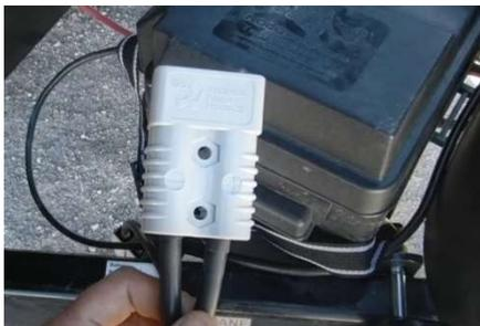
Para que a bateria possa ser conectada ao veículo elétrico ou ao carregador, é necessário que seja instalado um conector.
