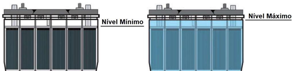
**Figura 10 – Níveis Máximo e Mínimo de Eletrólito.**
