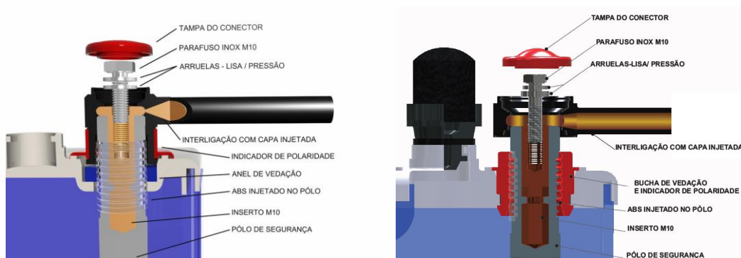
Fig.02 – Vedação Polo Tampa – Desenho Ilustrativo “A” e “B” bucha única de vedação
