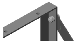
FIG.28- Fixação do Quebra-Vento-Tirante Isoladores
